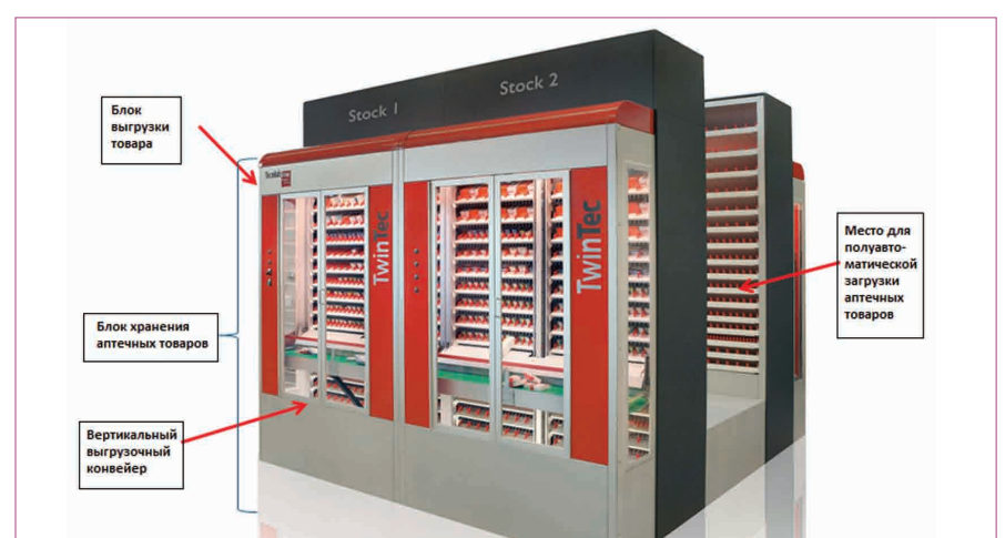
Рис. 2 Внешний вид устройства, реализующего технологию «физических каналов»
